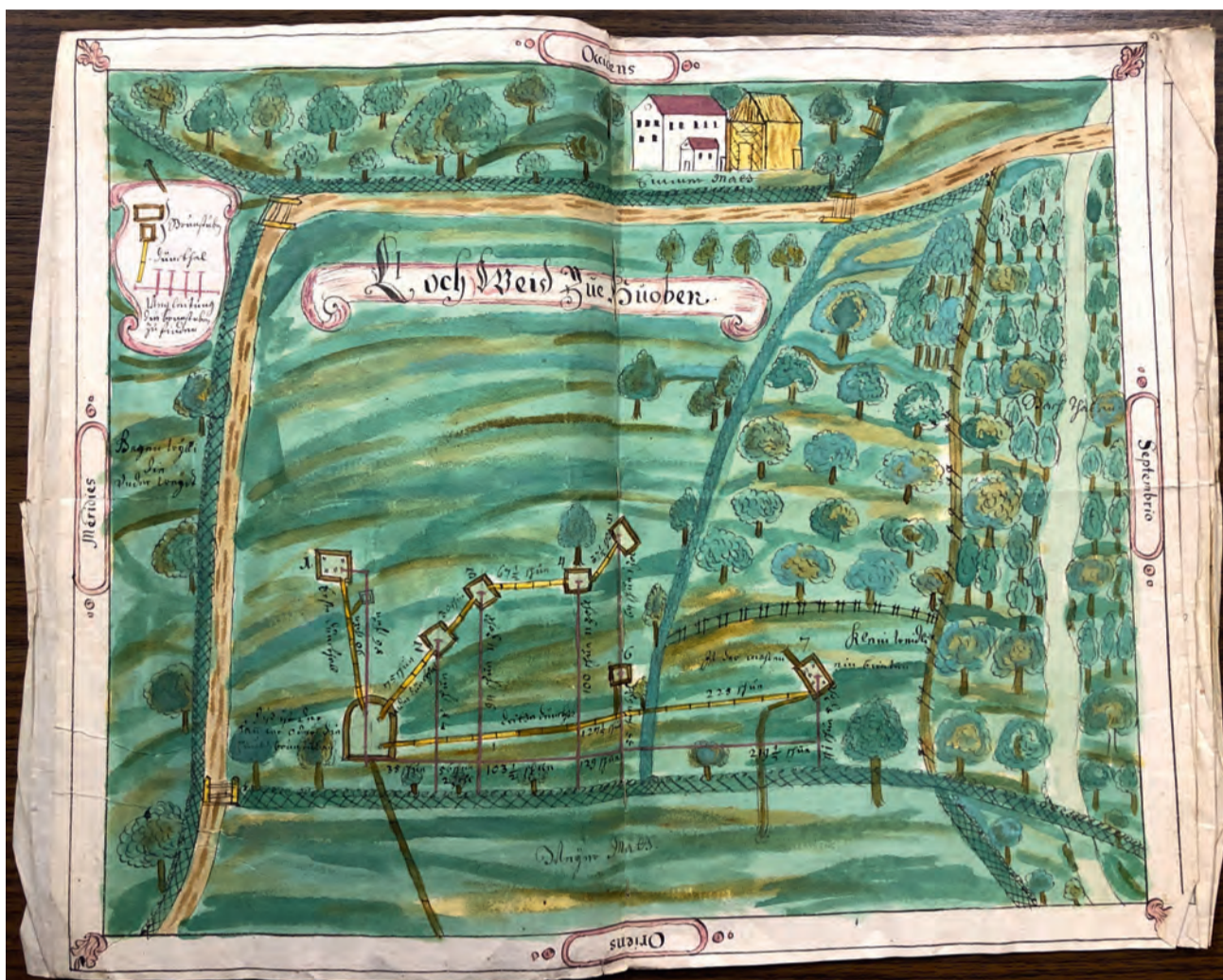
«Lochweid züe Hüoben»: Plan der Brunnstuben und Dünkel (Wasserleitungen aus Holz) im Gebiet Schössli und Kapelle Hueben aus dem Jahr 1753.
